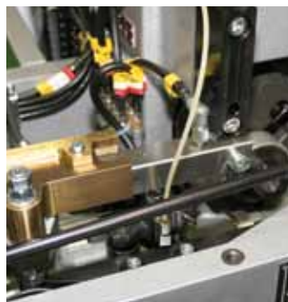
▲ Präziser Drahteinzug mit mechanisch gesteuertem Meißel
