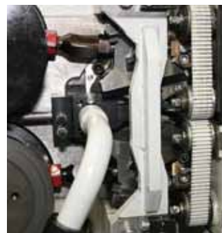
▲ Ankeifen der Nagelspitze und Absaugung des Spitzenschrotts
