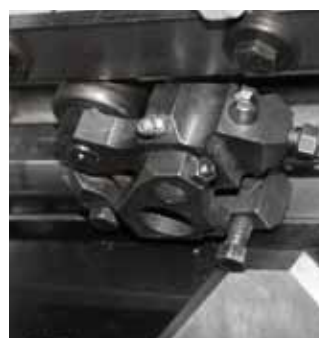
▲ Alimentación optimizada del cincel para lograr unas tolerancias de longitud estrechísimas
