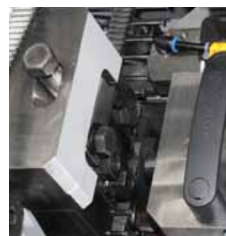
▲ Nueva disposición de las mordazas de presión incluso para la fabricación de clavos con cabeza en D y clavos de cabeza excéntrica
