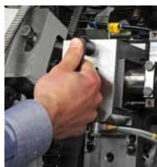
▲ El sistema de casete portapunzón reduce los tiempos de preparación para cambio de producto y permite fabricar clavos especiales
