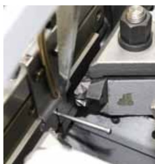
▲ Fabricación de remaches ciegos
